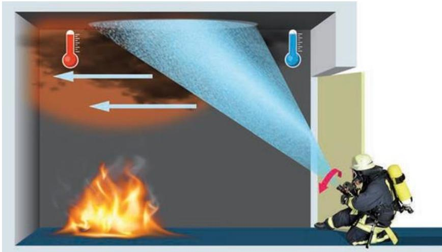
Die Strahlform des Sprühstrahls hängt von der Breite und Tiefe des Raumes und von der Wärmeentwicklung im Raum ab.
